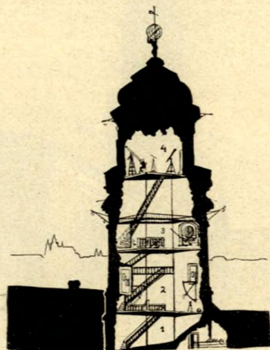
Obr. 2. Řez věží staré pražské hvězdárny v Klementinu.
